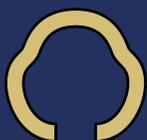
Clavo ranurado con sección en forma de hoja de trébol
